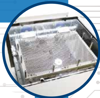
装置内的专利夹具将电路板上的电子部品进行固定
