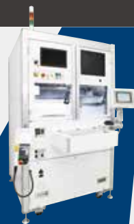
はんだ付け完了後、 オペレータの手元に排出
